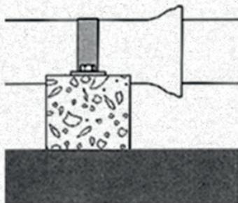
**ANCORE AS CONEXÕES E AS TUBULAÇÕES PARA QUE ELAS NÃO SE MOVIMENTEM.**
